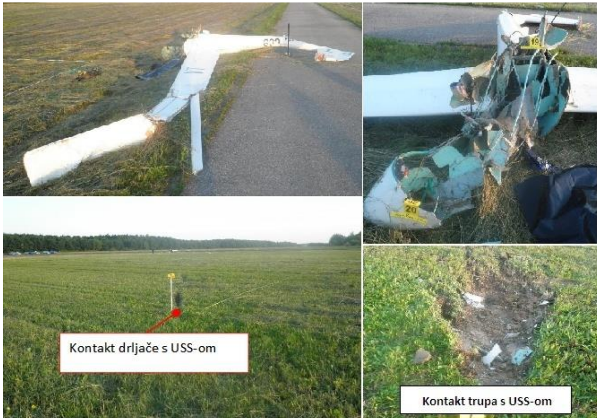
Slika 10. Oštećenja na jedrilici i USS-i [43]
