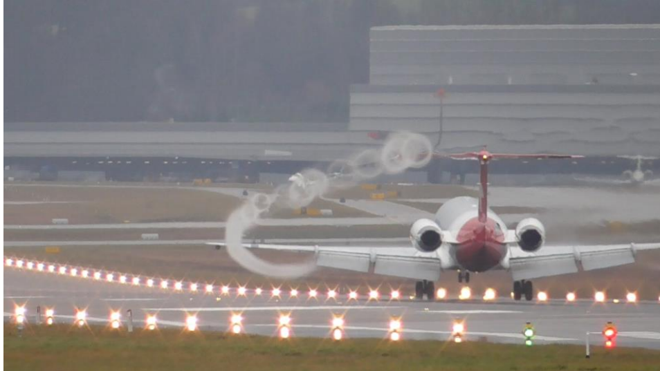
Slika 10. Raspadanje vrtložnih tragova pri slijetanju, [13]
