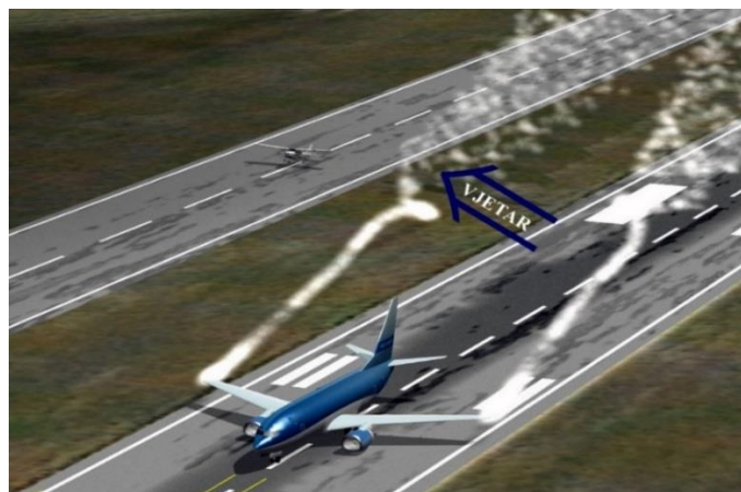
Slika 2. Utjecaj zemljine površine pri uvjetima bočnog vjetra, [14]
