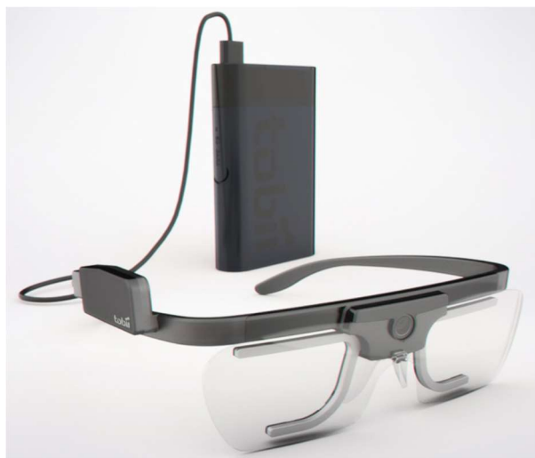
Slika 14. Tobii Pro naočale i uređaj za pohranu podataka
