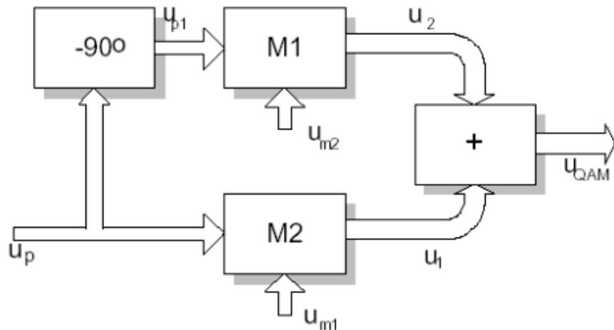
Slika 10. Dobivanje QAM signala prikazano blok shemom [12]
