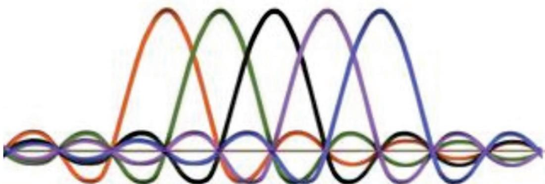
Slika 5. Ilustracija valnog oblika OFDM signala s 5 podnosiocima [5]
