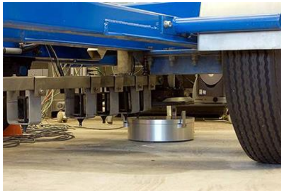
Slika 10. Suvremeno FWD vozilo za mjerenje stanja kolnika
