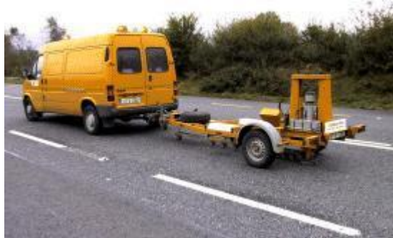
Slika 9. FWD vozilo za mjerenje stanja kolnika
