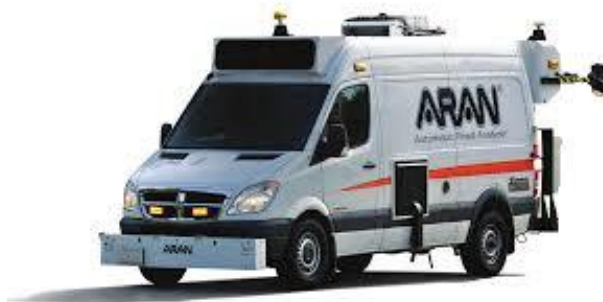
Slika 7. Suvremeno ARAN vozilo za mjerenje kolnika
