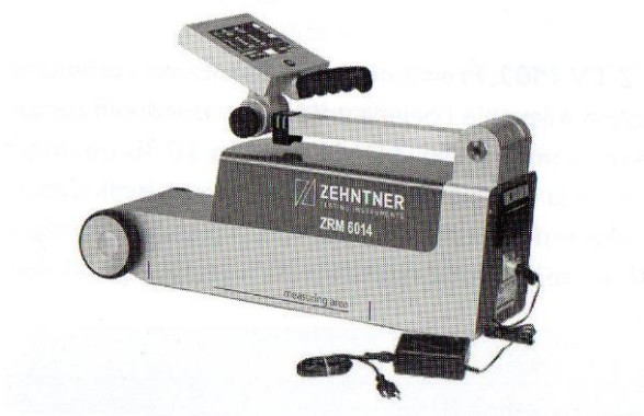
Slika 15. Uređaj za ispitivanje retrorefleksije oznaka na kolniku
