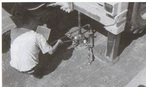
Slika 11. Ispitivanje modula stišljivosti kružnom pločom promjera 300mm
