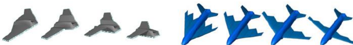
Slika 11. Koncepti morfoze krila zrakoplova MAS programa: lijevo - Lockheed – Martin, desno - NextGen Aeronautics
