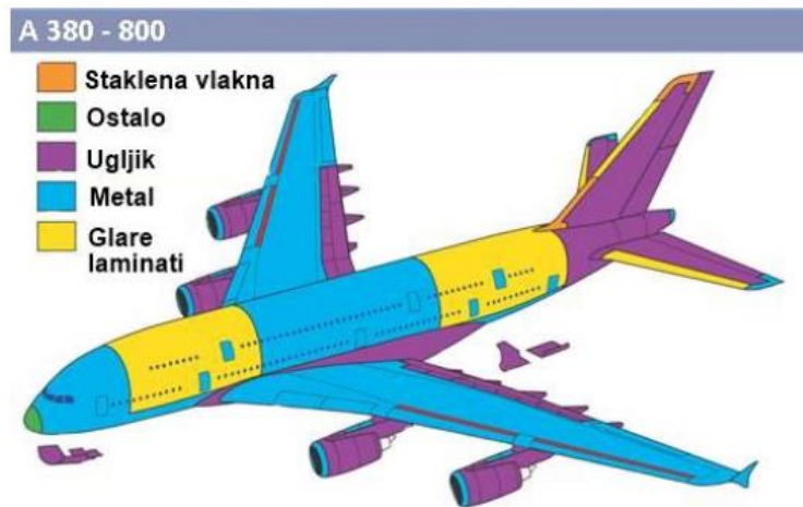
Slika 14. Raspodjela materijala na zrakoplovu A380-800
