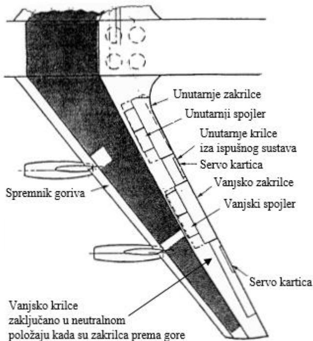
**Slika 10.** Pozicija zakrilca, spojlera i krilca na krajevima krila Boeinga 707
