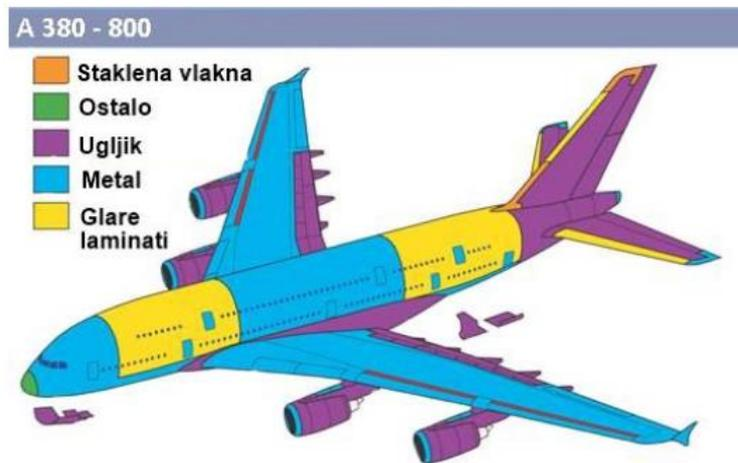
**Slika 14.** Raspodjela materijala na zrakoplovu A380-800
