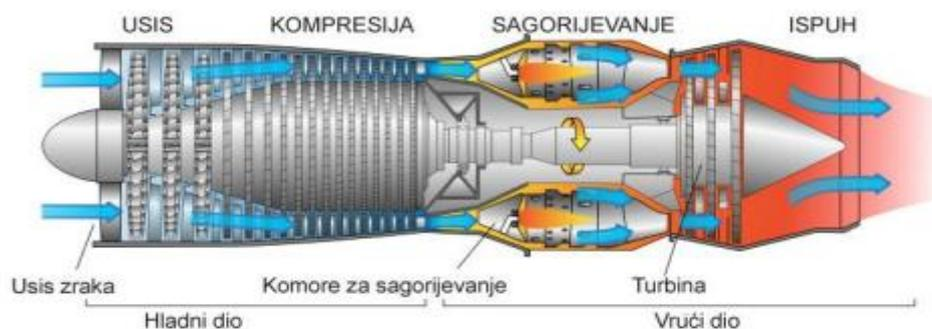
**Slika 1.** Presjek turbo – mlaznog motora
