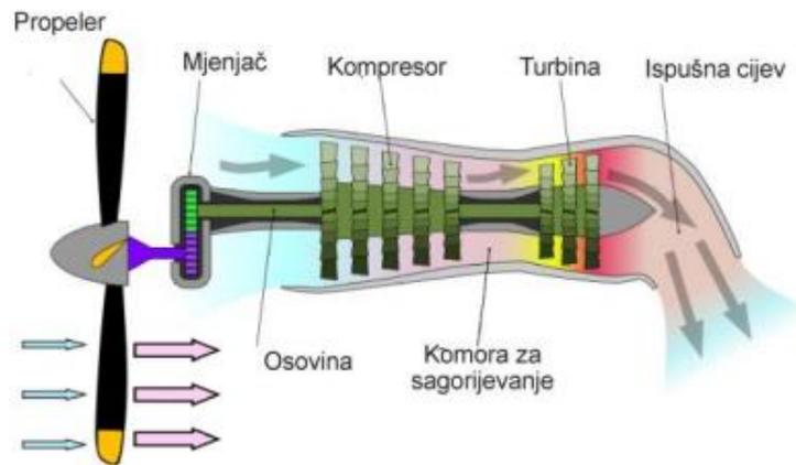
**Slika 3.** Presjek turbo – propellerskog motora
