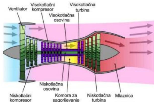
**Slika 2.** Presjek turbo - ventilatorskog motora
