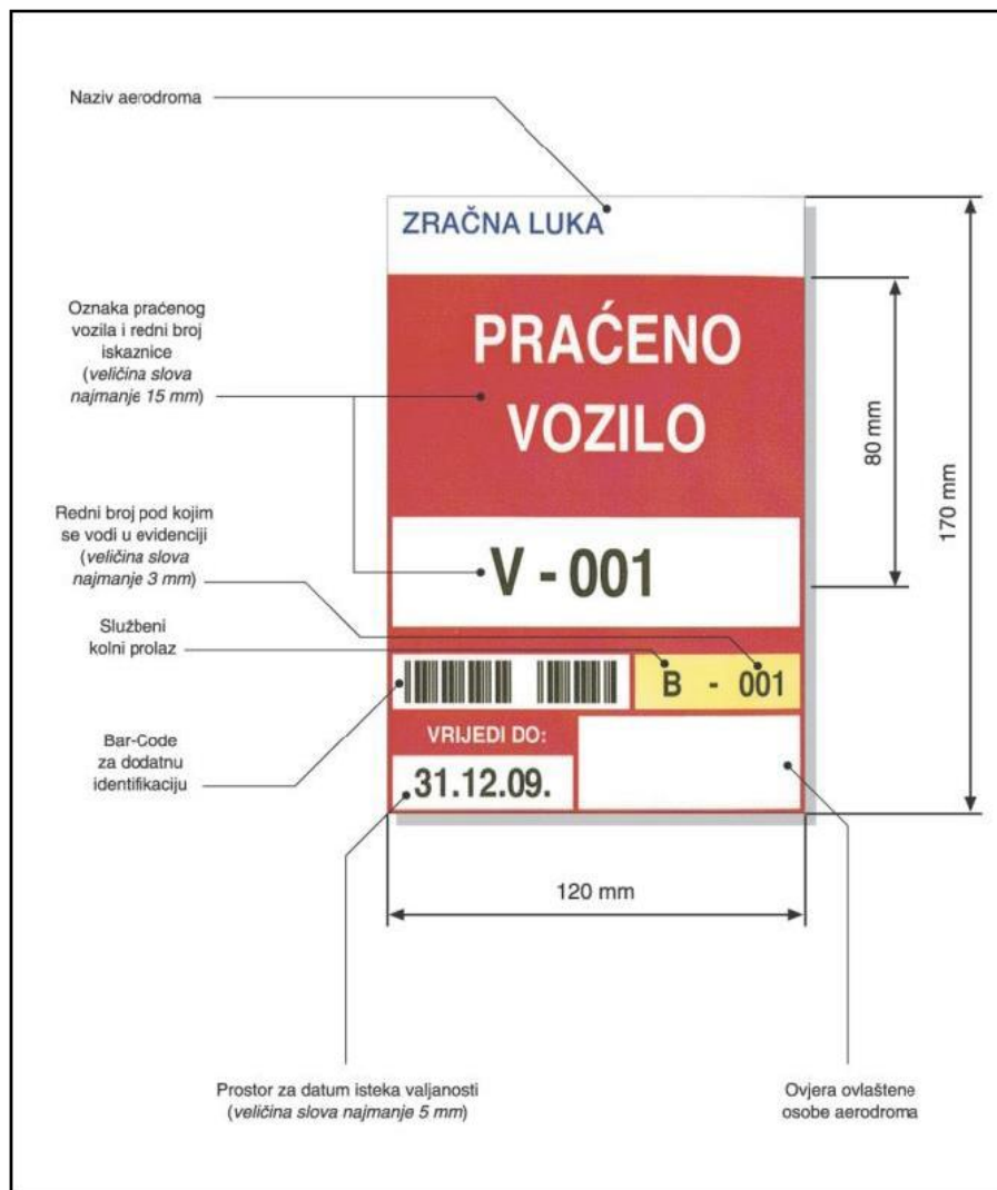
Slika 7.: Identifikacijska iskaznica za praćeno vozilo
