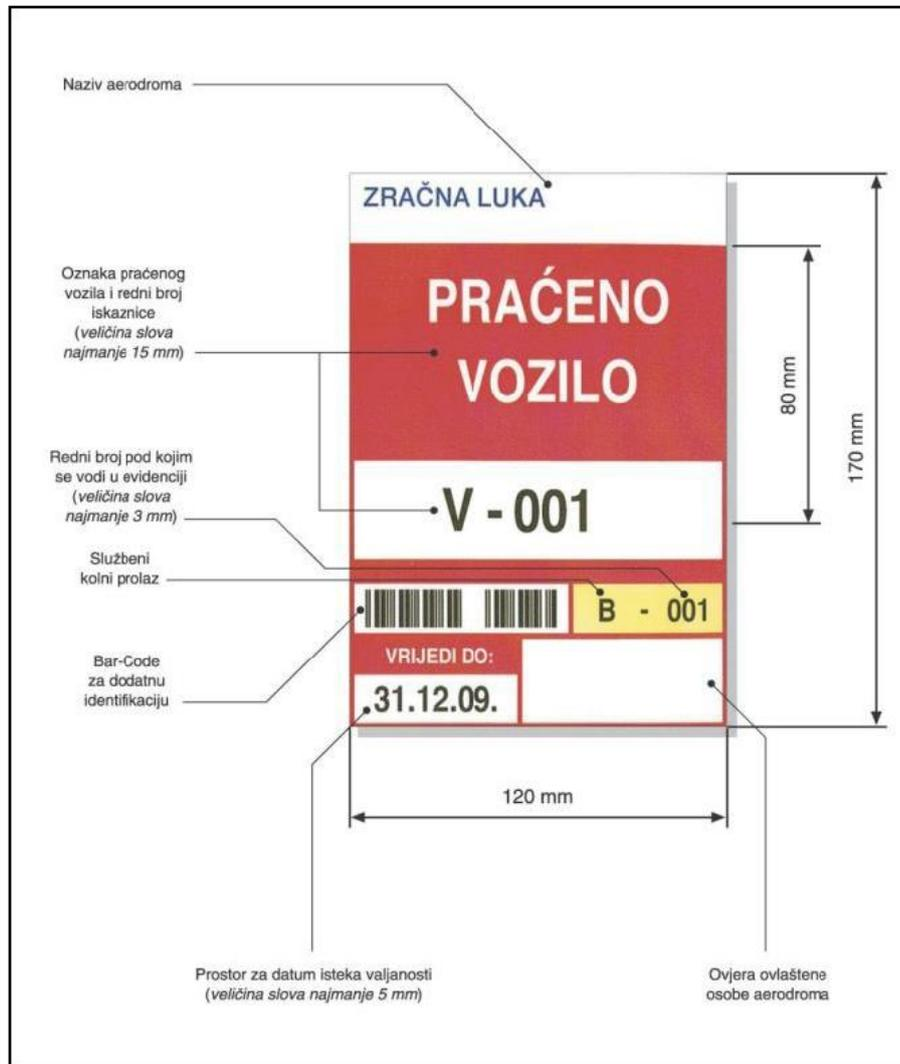
**Slika 7.:** Identifikacijska iskaznica za praćeno vozilo
