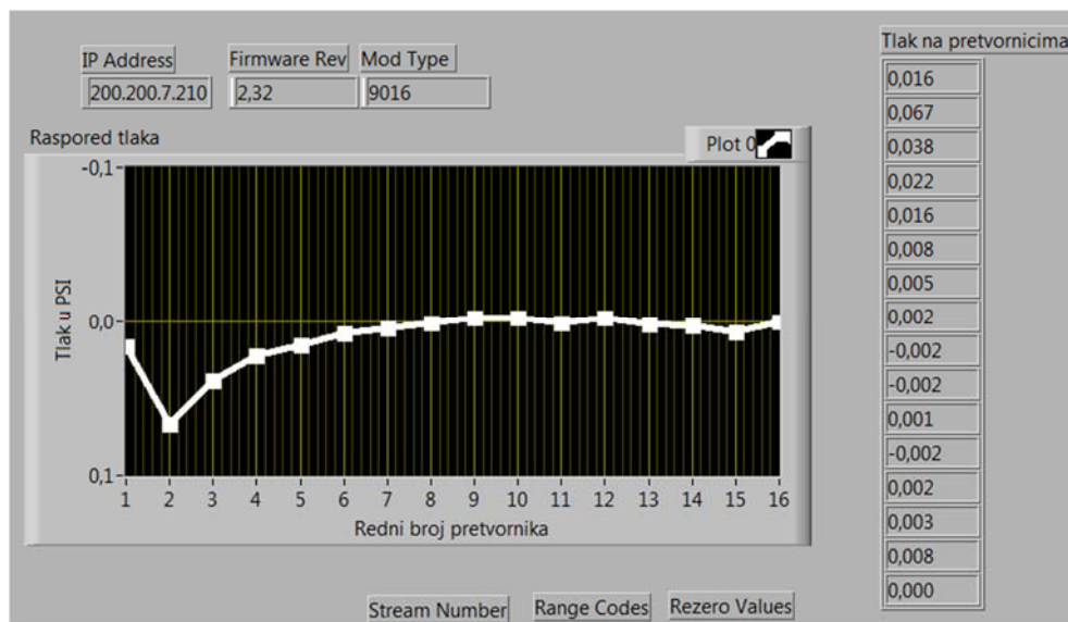
Slika 55. Raspored tlaka na donjaci pri 35 Hz
