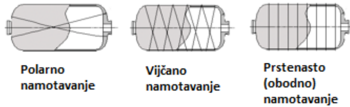
Slika 5. Načini namotavanja vlakana
