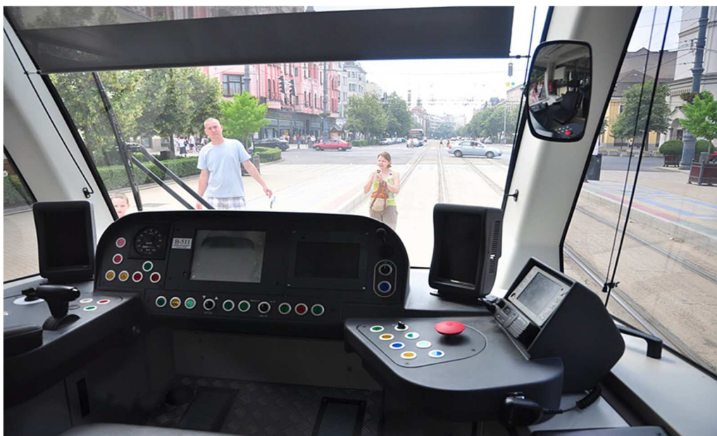
Slika 49. Vozačka kabina u tramvaju Urbos 3
