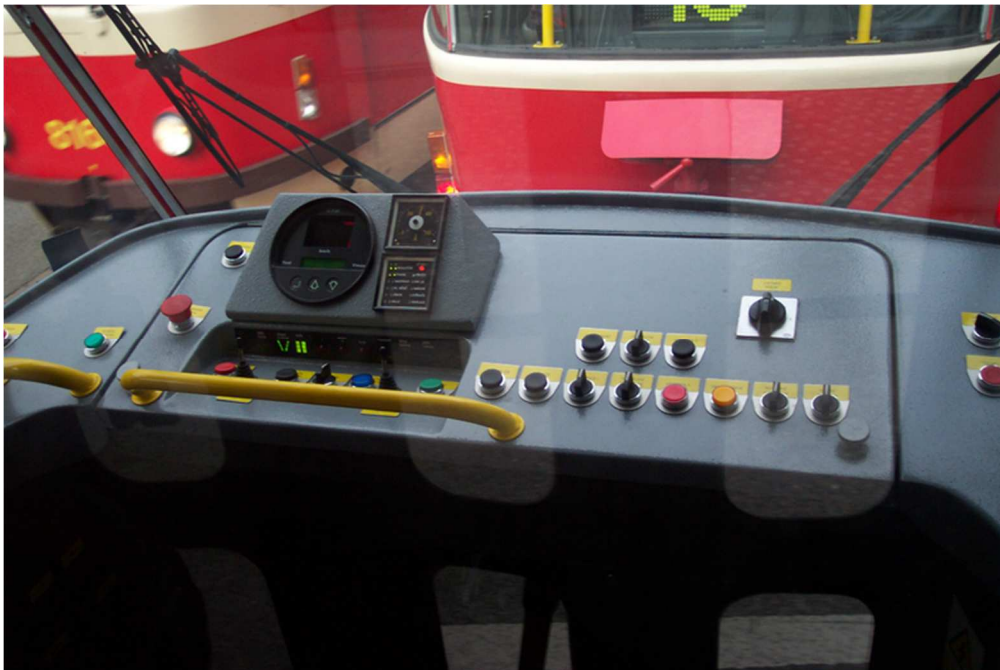
Slika 9. Vozačka kabina u tramvaju Tatra T3R.P
