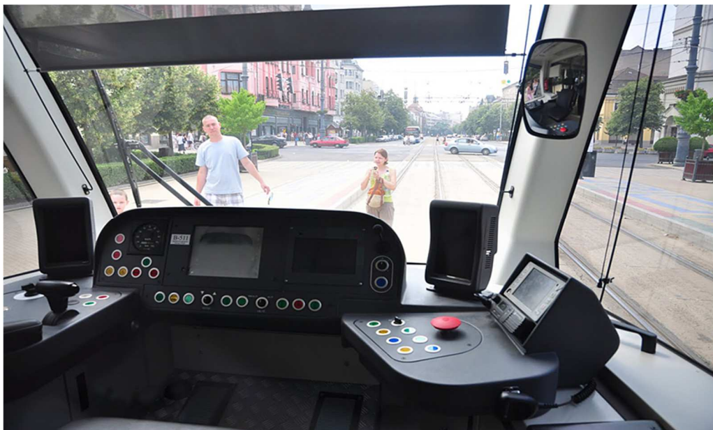
Slika 49. Vozačka kabina u tramvaju Urbos 3
