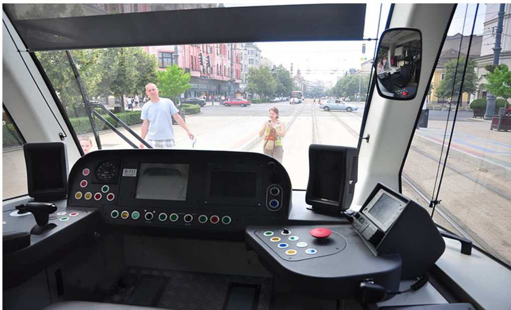
Slika 49. Vozačka kabina u tramvaju Urbos 3
