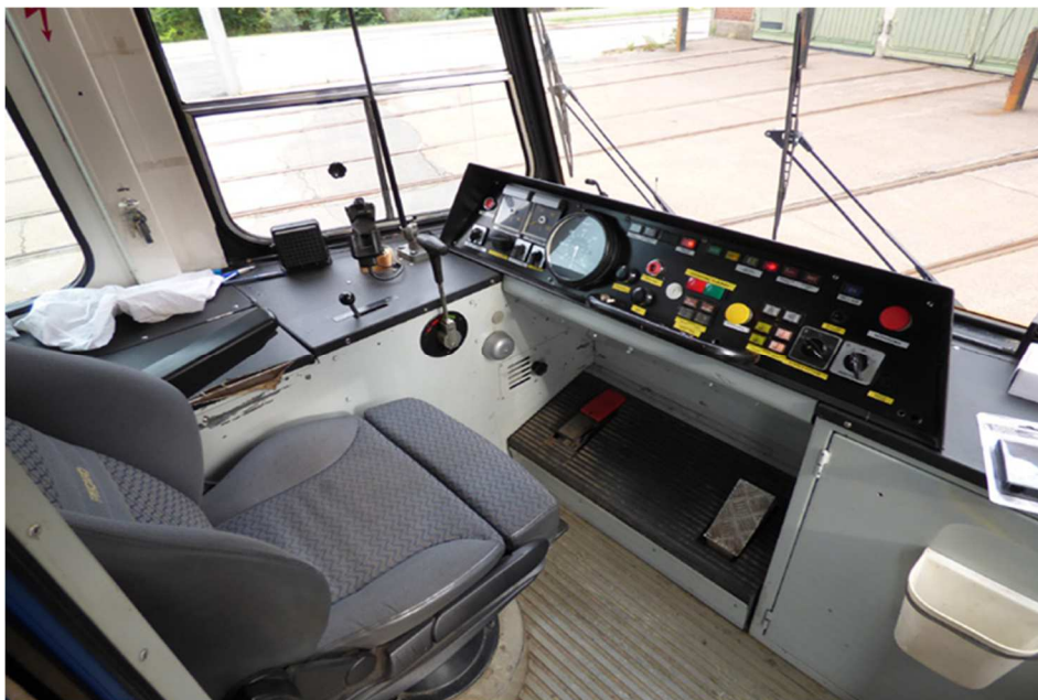
Slika 37. Vozačka kabina u tramvaju Tatra T5C5
