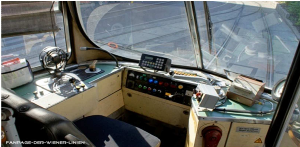
Slika 58. Vozačka kabina u tramvaju E1
