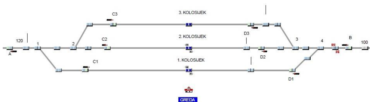
Slika 6. Kolosiječna shema kolodvora Greda
