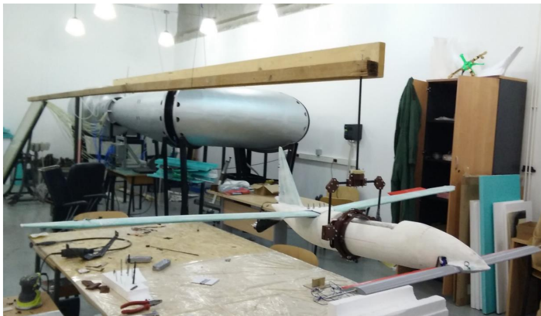
Slika 15 - Letjelica SOVA ovješena na kardanskom ovjesu
