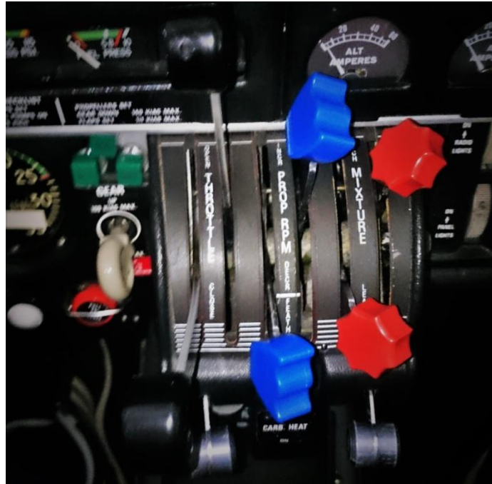
Slika 23: Pozicija komandi pogonskog sustava u slučaju otkaza lijevog motora, [4]
