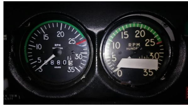
Slika 14: Instrument za mjerenje broja okretaja – RPM,[4]
