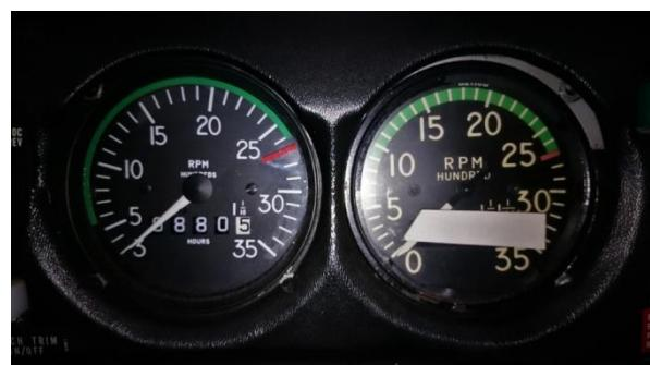
Slika 14:Instrument za mjerjenje broja okretaja – RPM,[4]
