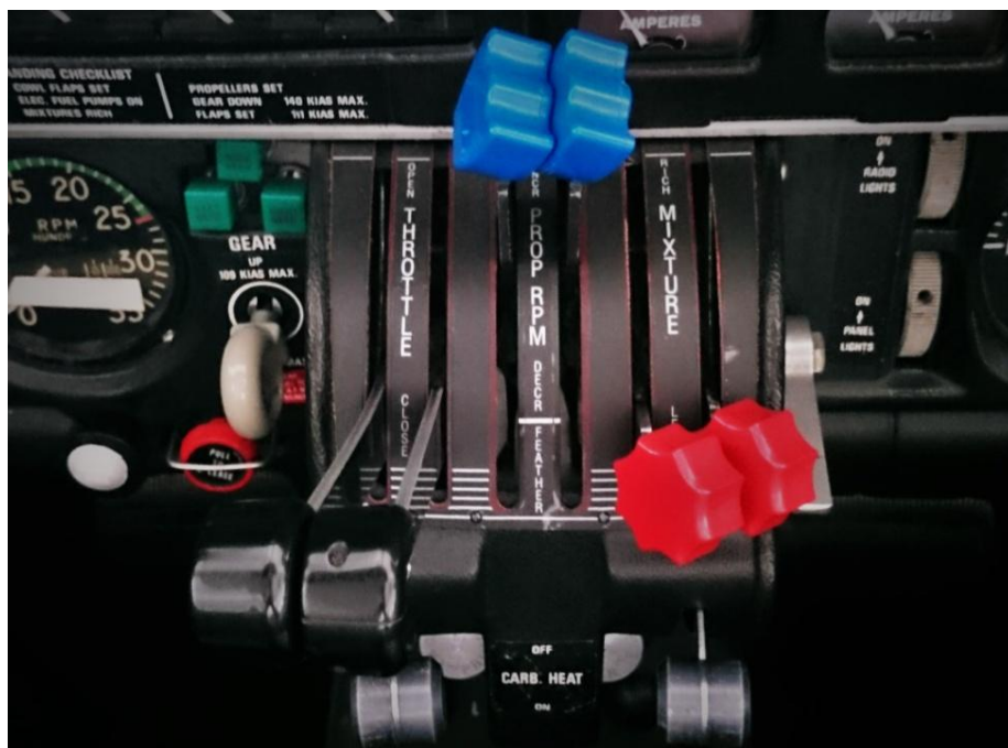
Slika 22: Postavka komandi za zaustavljanje rada motora, [4]
