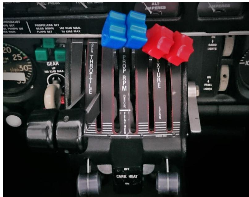
Slika 21: Postavka snage kod spuštanja i slijetanja, [4]
