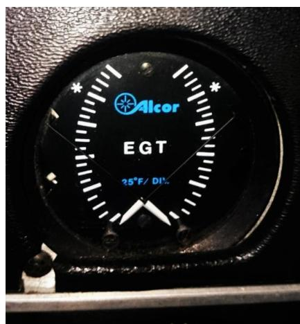
Slika 15:Instrument za mjerjenje temperature ispušnih plinova – EGT,[4]
