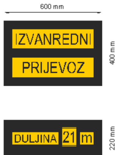
Slika 5 Skica oznake "Izvanredni prijevoz" i dodatne oznake "duljina....m"
