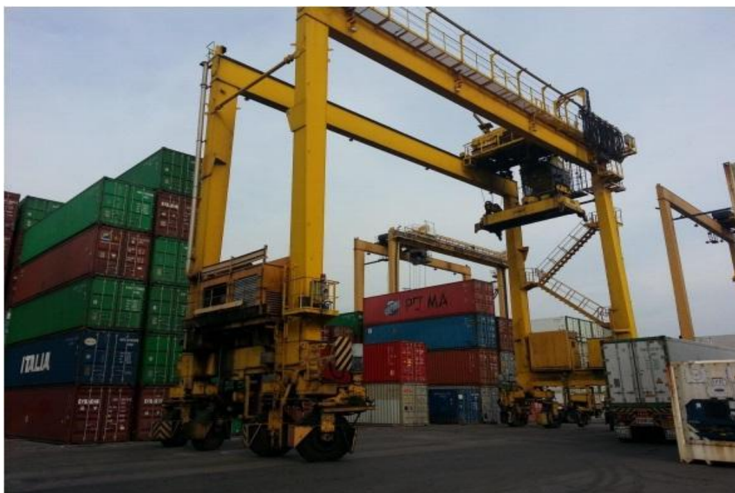
Slika 26. Portalni prijenosnik velikog raspona
