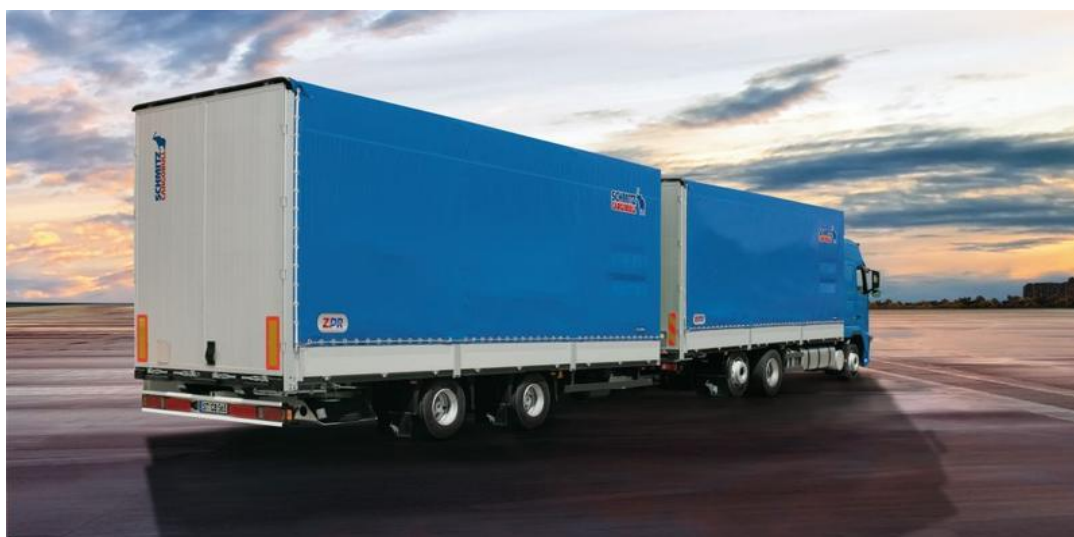
Slika 30. Kamion s prikolicom duljine 7,3 + 8,2 m
