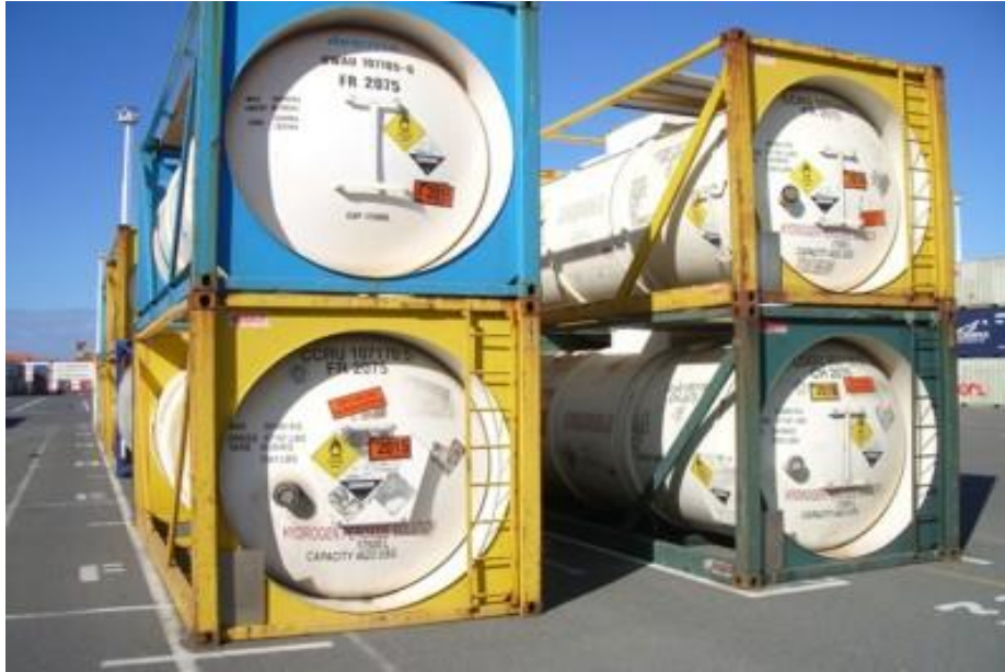
Slika 14. Primjer slaganja opasnog tereta na terminalu Tauranga, Novi Zeland
