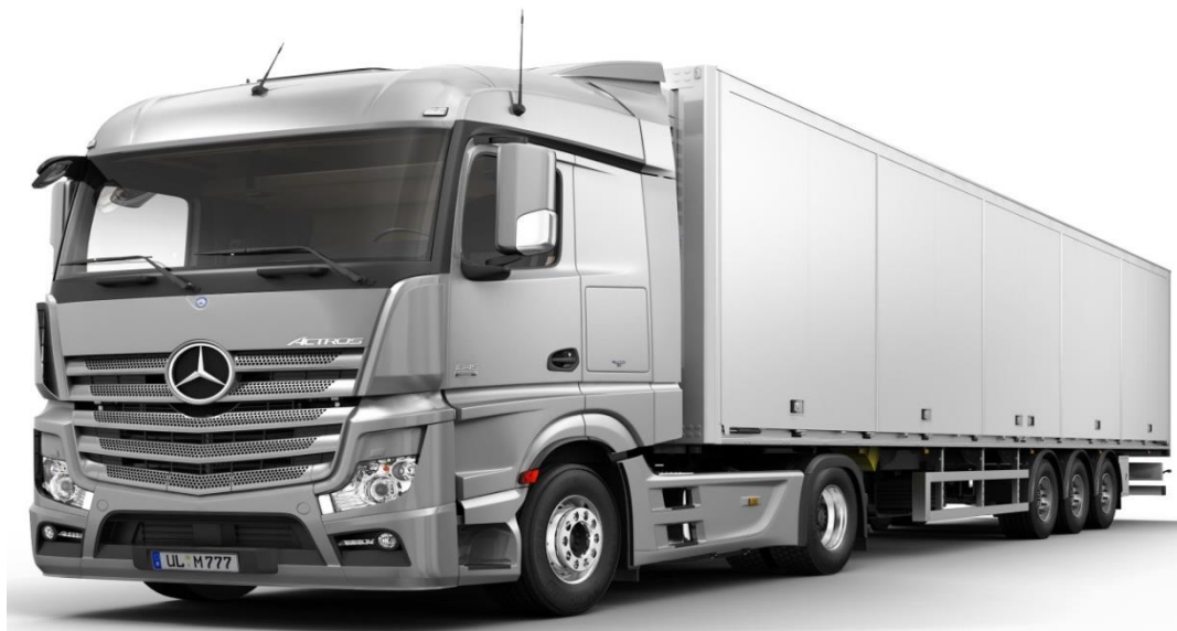
Slika 31. Tegljač s poluprikolicom duljine 13,6 m
