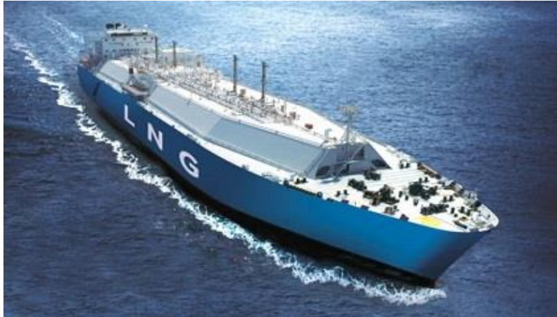
Slika 4: Membranski UPP brod
