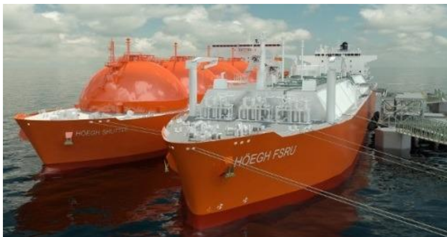
Slika 10: Plutajući terminali za skladištenje i uplinjavanje UPP-a
