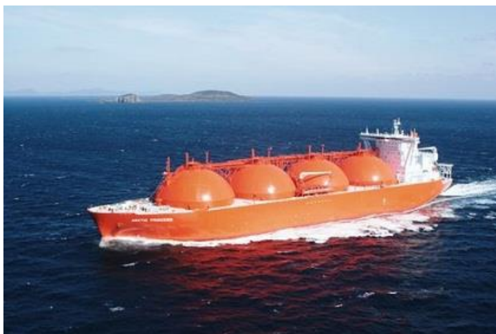
Slika 3: UPP brod sa sfernim tankom
