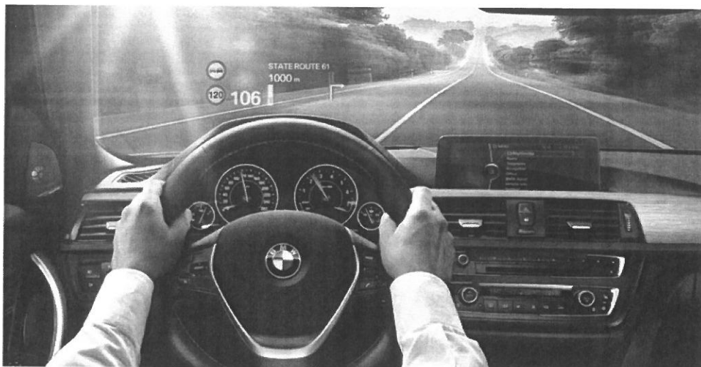
Slika 8. Heads-up display u vozilu, [19]
