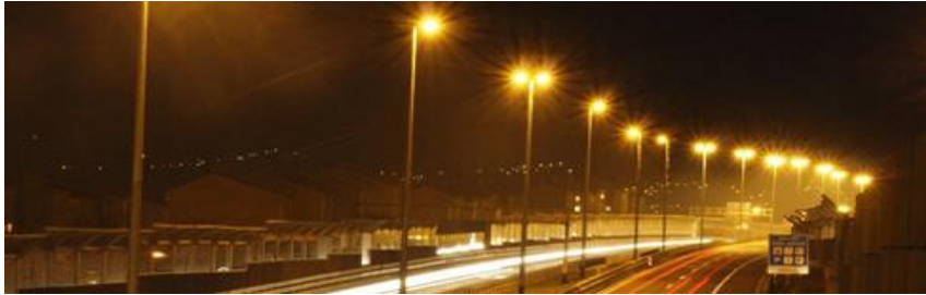
Slika 16. - Centralni raspored izvora svjetlosti
