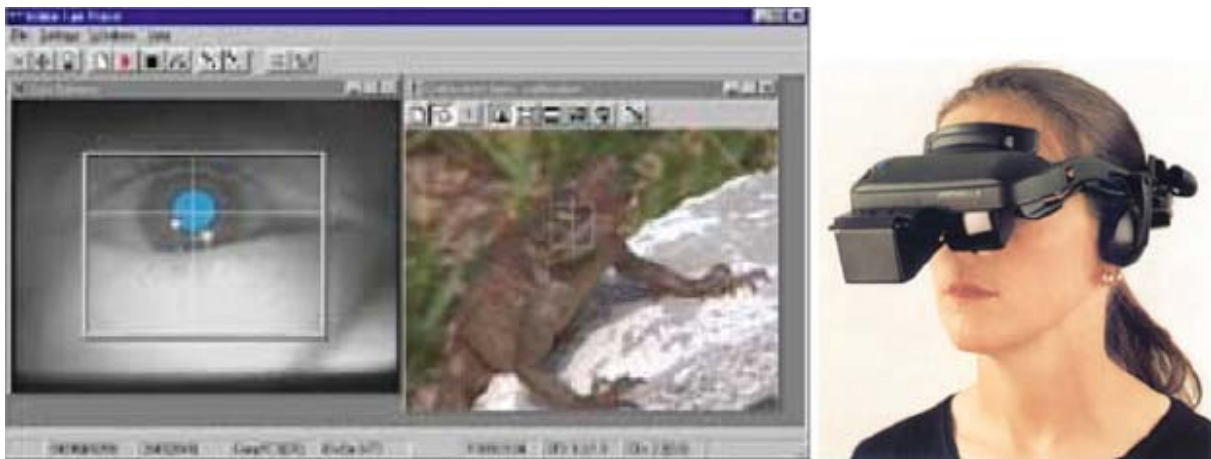
Slika 14. Uređaj za praćenje pogleda baziran na video snimanju koji se nosi na glavi
