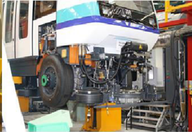
Slika 32: Prikaz sustava vlaka na gumenim kotačima kod vlaka „VAL 208“.
