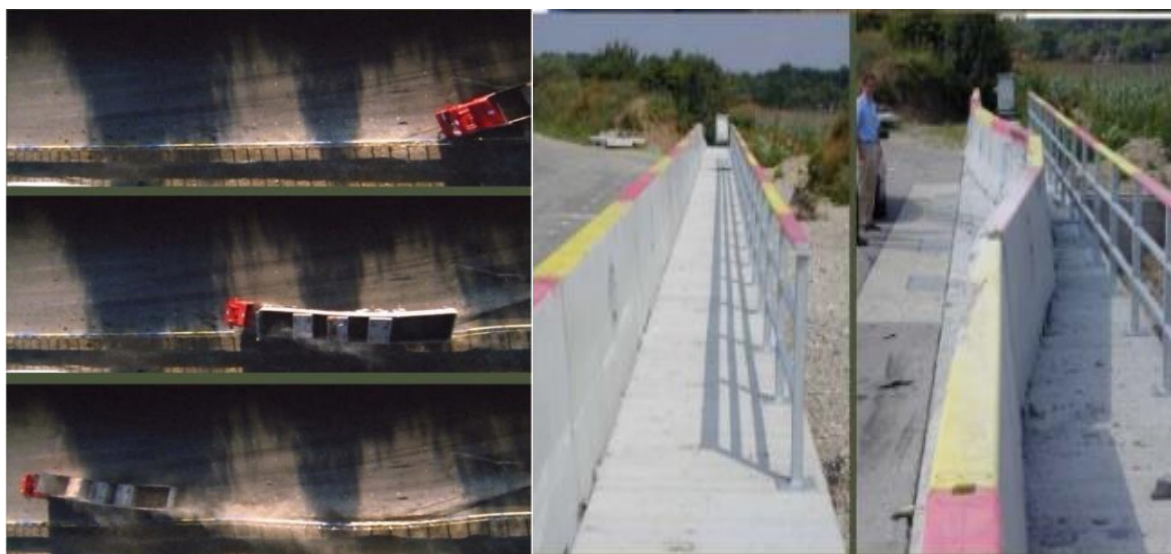
Slika 25. Primjer zadržavanja vozila pri udara u ogradu, [23]
