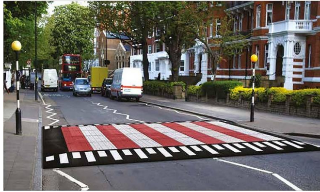
Slika 65: Umjetne izbočine ili uspornici, [43]
