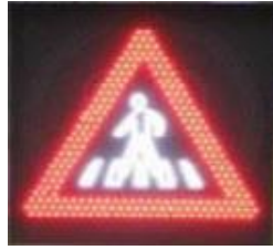
Slika 55. Vidljivost simbola prometnog znaka izrađenog u LED tehnologiji, [41]
