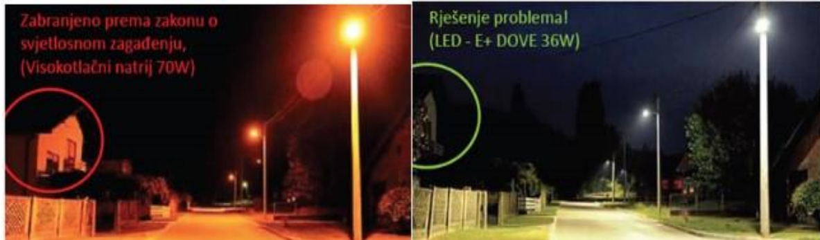
Slika 54. Prikaz jačina raspršivanja svjetlosti LED dioda i običnih žarulja, [40]
