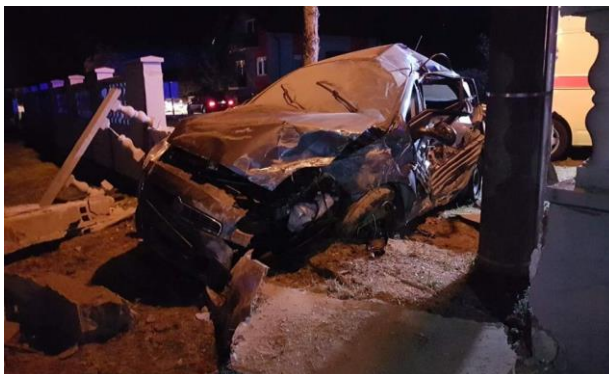
Slika 50: Posljedice nesreće zbog nezaštićene ograde, [38]
