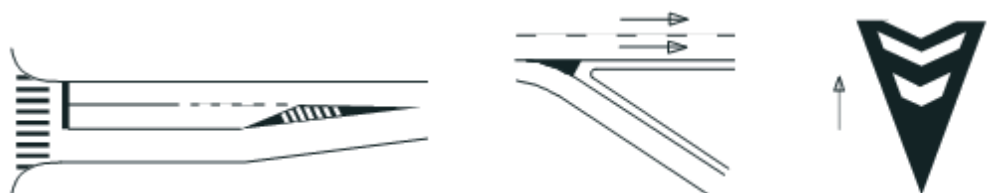
Slika 16. Primjeri polja za usmjeravanje prometa, [28]
