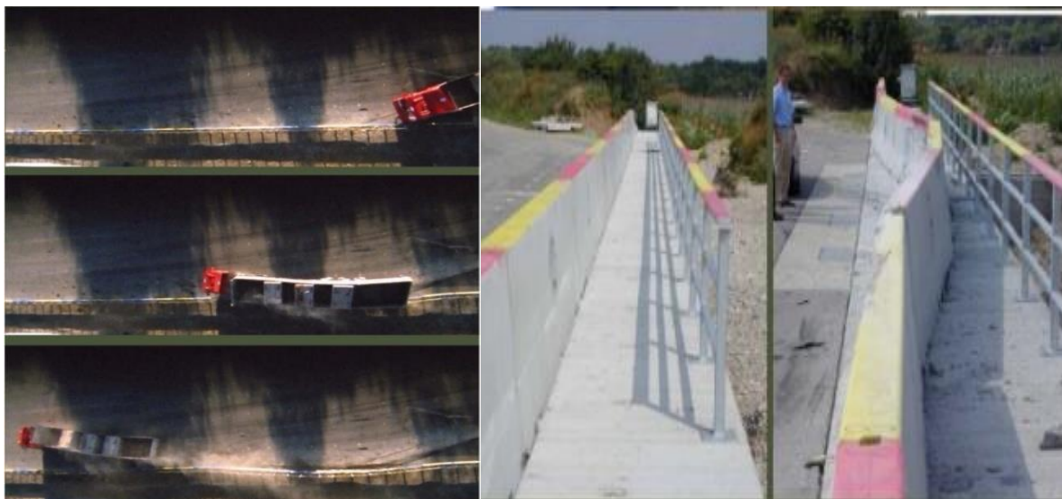
Slika 25. Primjer zadržavanja vozila pri udara u ogradu, [23]
