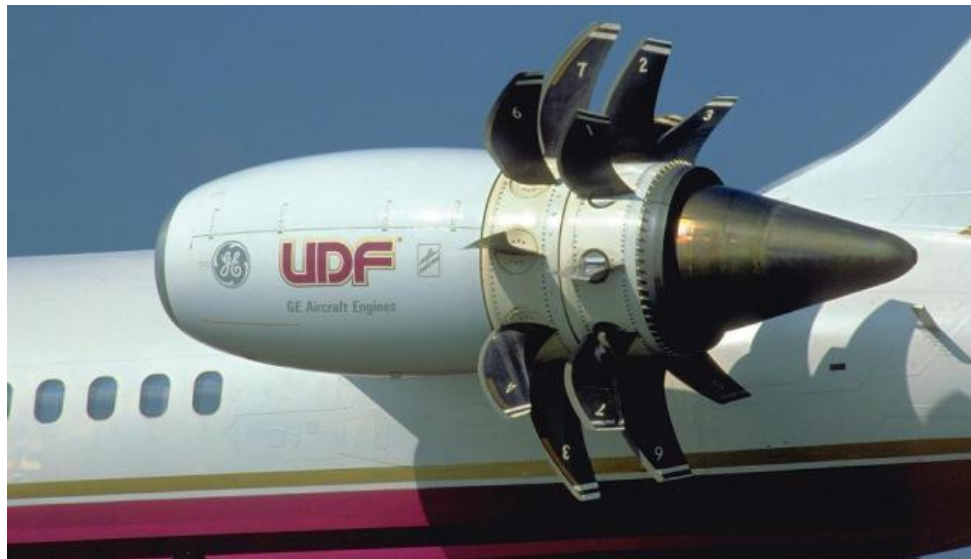
Slika 16. GE36 propfan motor u fazi testiranja na zrakoplovu MD80 [14]
