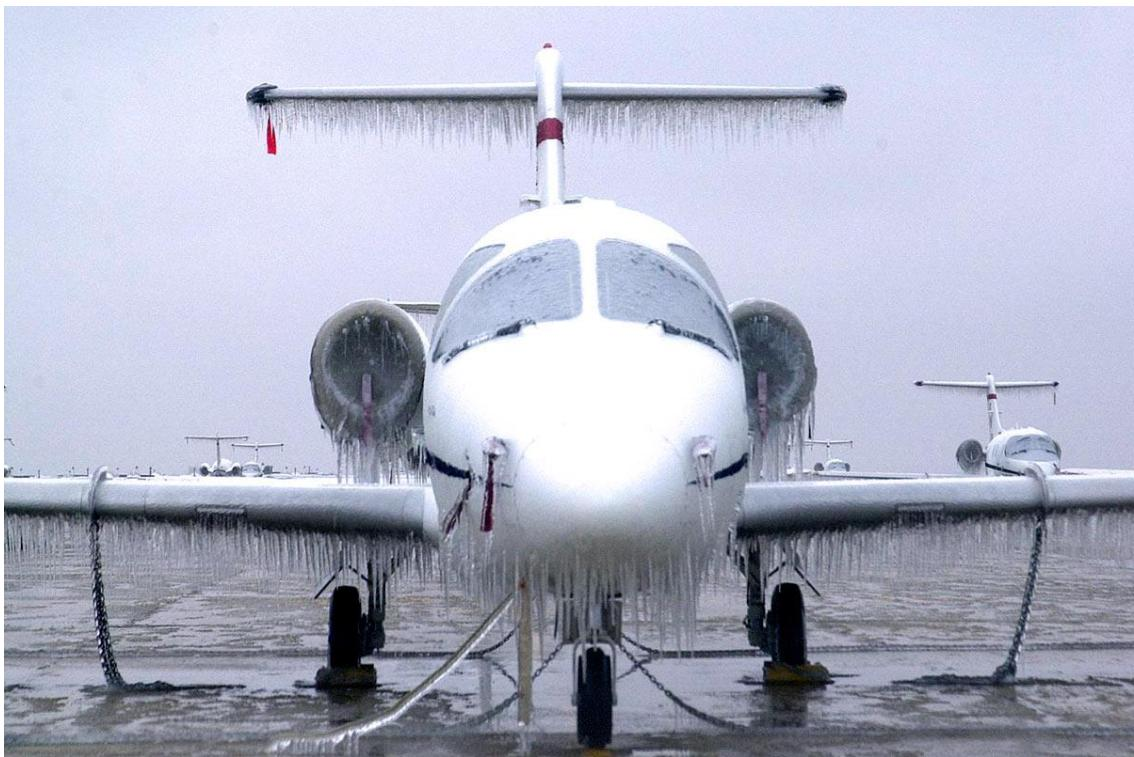
Slika 1. Potpuna kontaminacija površine zrakoplova ledom
