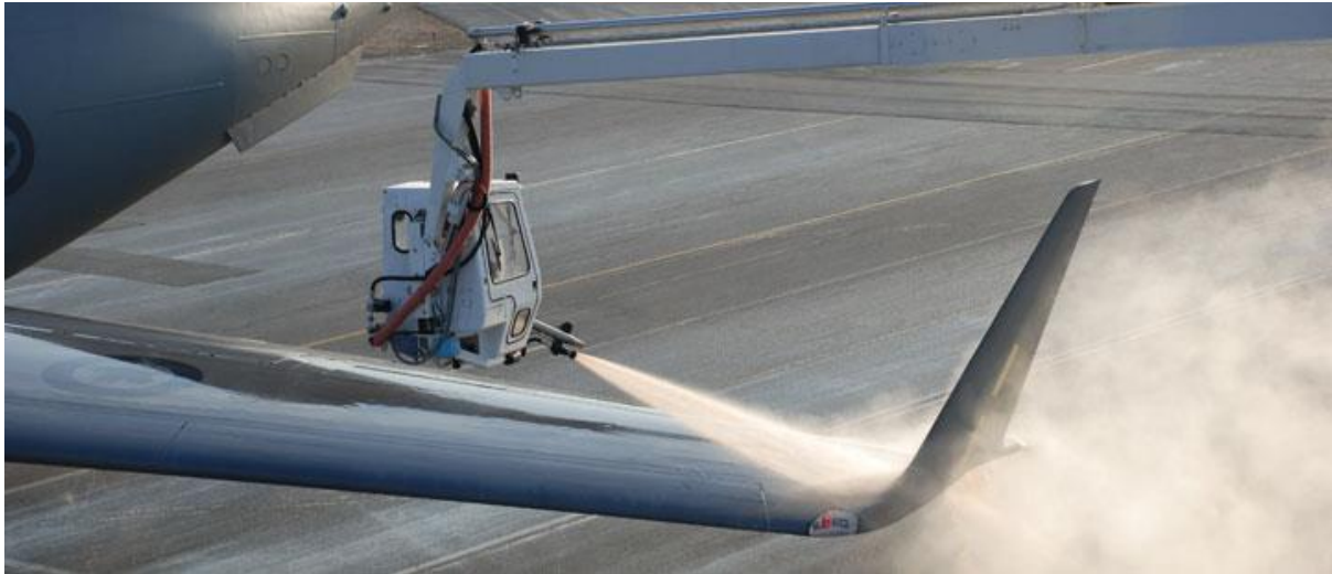
Slika 2. Nanošenje presvlake fluida za zaštitu od zaleđivanja na površinu zrakoplova
