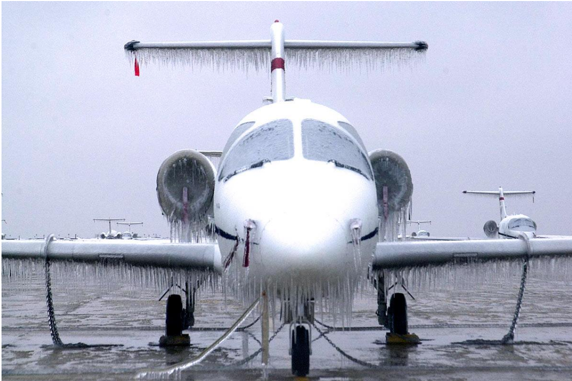
Slika 1. Potpuna kontaminacija površine zrakoplova ledom
