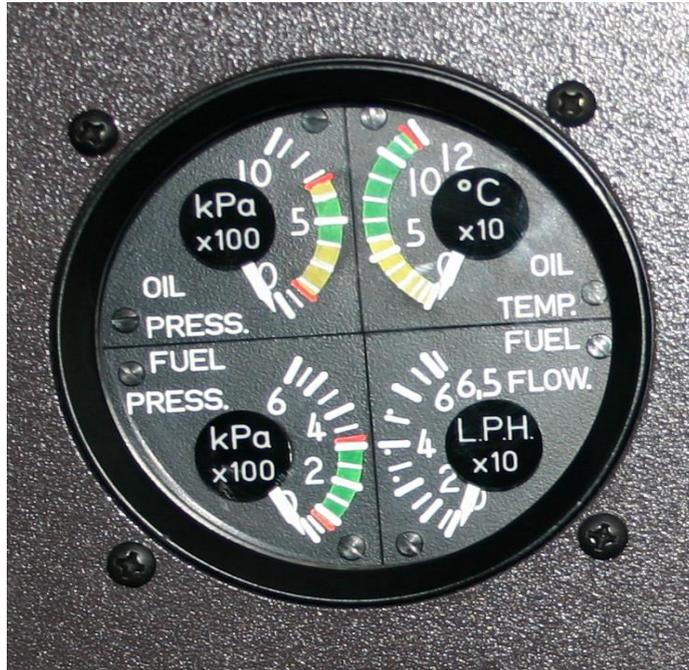
Slika 6. Četverodijelni instrument<sup>19</sup>
