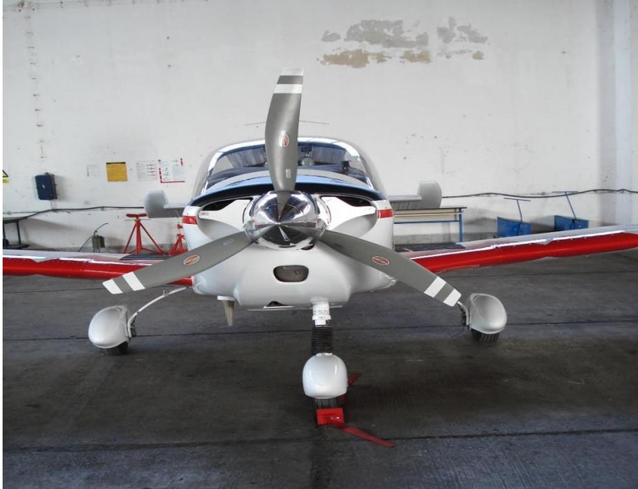
Slika 4. Usisni otvori na prednjem dijelu nosa zrakoplova<sup>10</sup>
