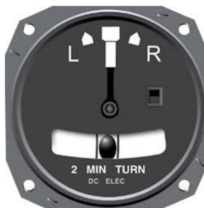
Slika 5.4.1.2. Prikaznik skretanja i klizanja [8]
