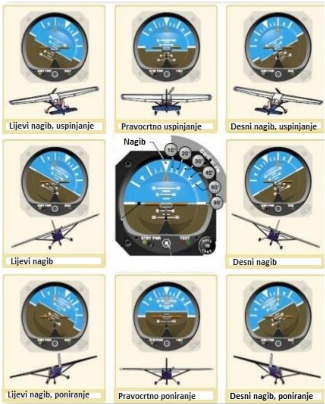
Slika 5.6.1.4. Prikazivanje umjetnog obzora [16]
