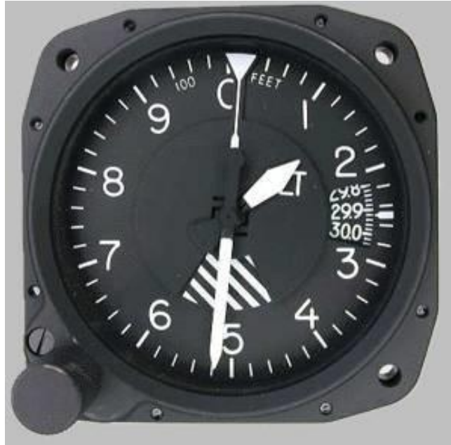
Slika 4.4.1.2. Prikaznik mehaničkog OBV-a [4]
