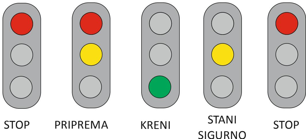
*Slika 9: Redoslijed paljenja semafora za vozače s tumačenjem pojedinih faza*
