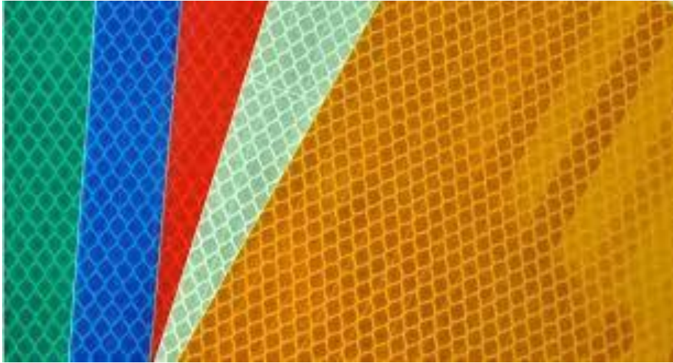
Slika 17. Retroreflektirajuće folije klase III
