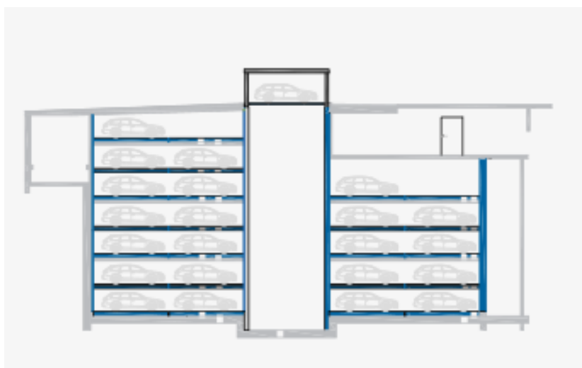
Slika 8.: Djelomično mehanizirana garaža sa dizalom; [10] www.koch.hr
