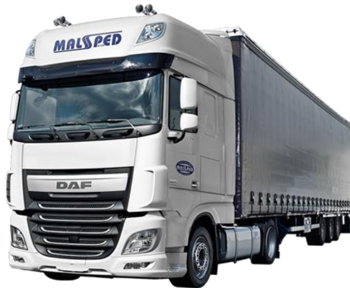
Slika 3. Dvoosovinski tegljač sa troosovinskom poluprikolicom
