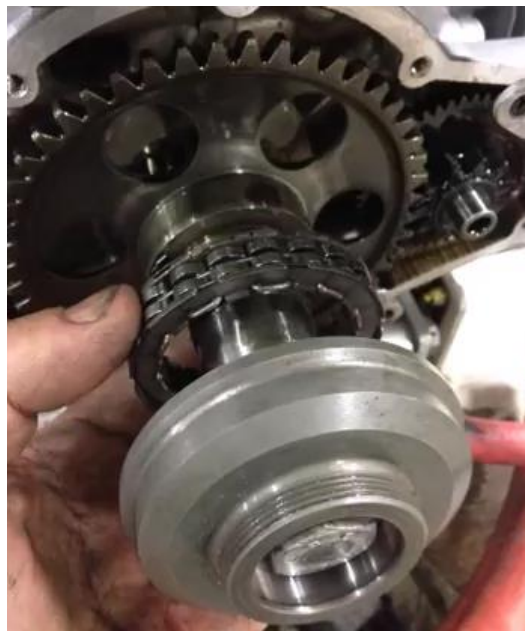
Slika 13. Sklop sustava za pokretanje na motoru Rotax 912 S
