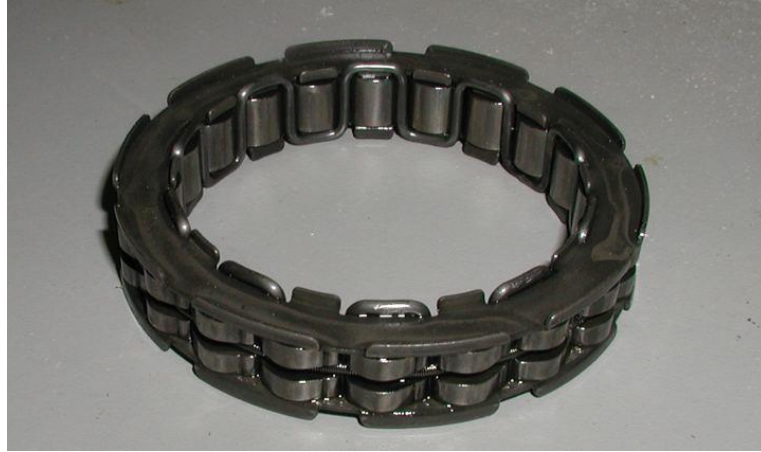
Slika 12. Jednosmjerna spojka na motoru Rotax 912 S
