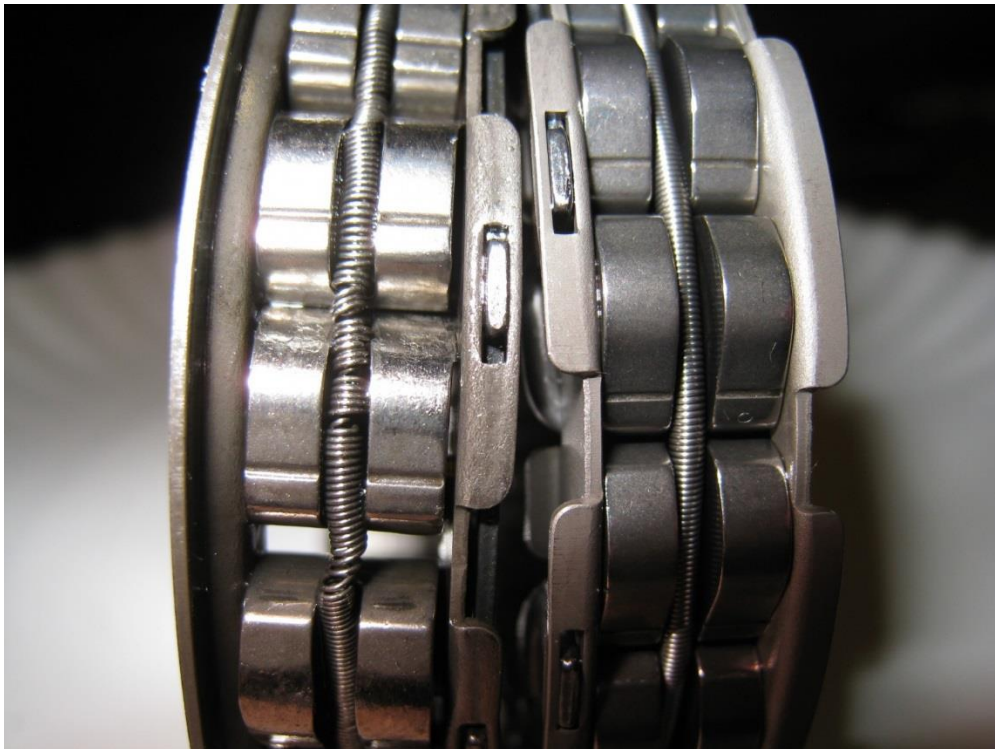
Slika 15. Oštećena jednosmjerna spojka
