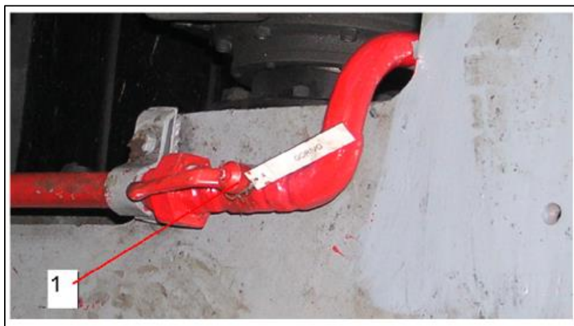
Slika 29. Slavina za zatvaranje napajanja goriva dizel motora (1)
