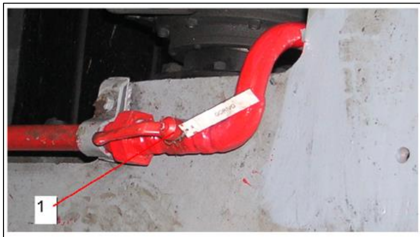
Slika 29. Slavina za zatvaranje napajanja goriva dizel motora (1)
