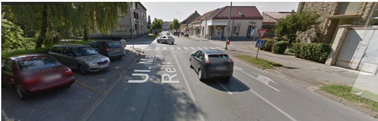
Slika 3.10. Horizontalna preglednost na raskrižju 3 (sjeverni privoz), [1]
