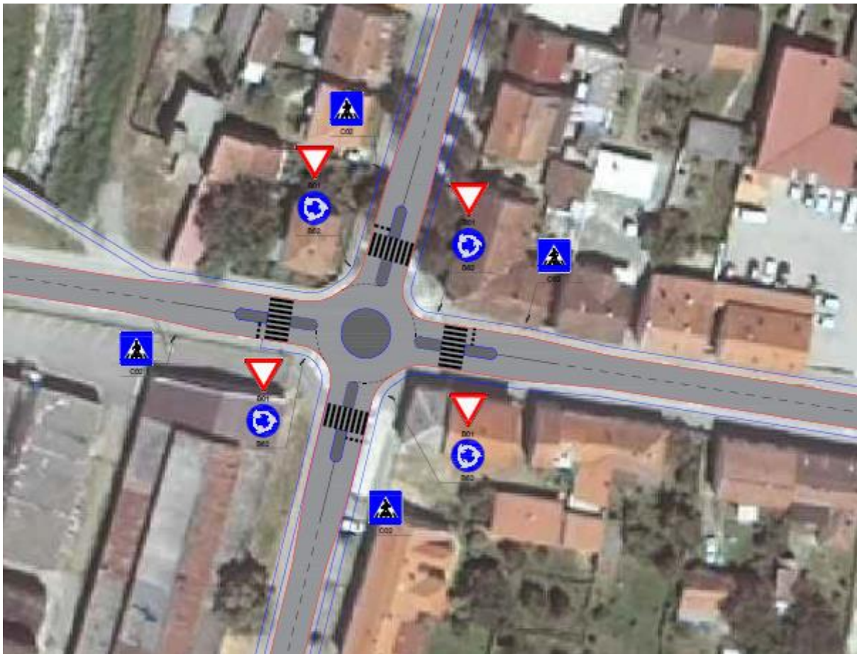
Slika 5.6. Idejno rješenje rekonstrukcije raskrižja 2 (križanje Ulice Alojzija Stepinca, Ulice Nikole Tesle i Potočne ulice)
