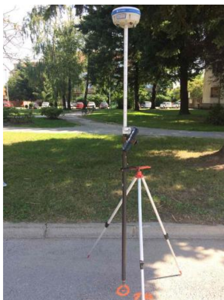
Slika 5.4 Određivanje koordinata poligona GPS prijemnikom
