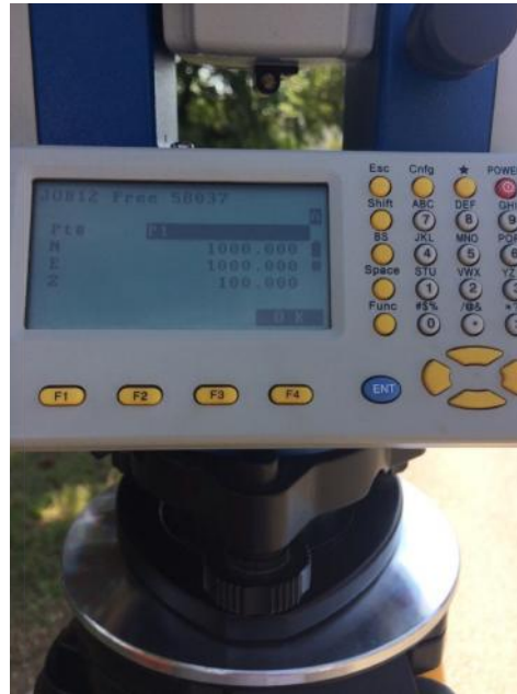
Slika 5.10. Postavljanje koordinata točke P1
