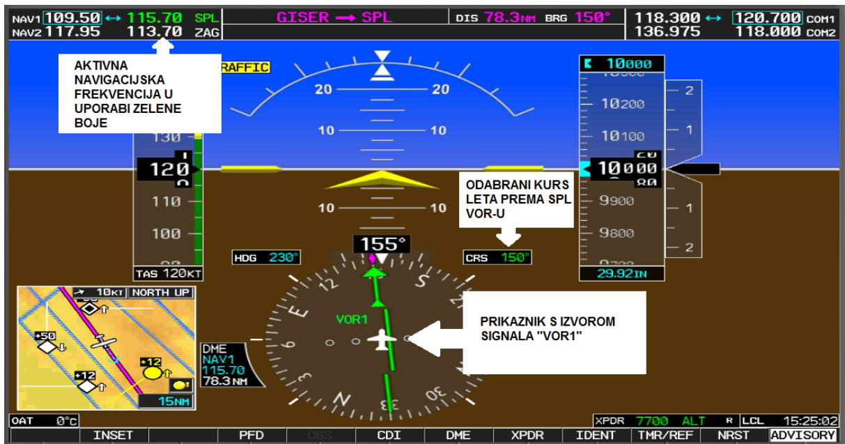
Slika 22. Primarni letni prikaznik s VOR izvorom signala
