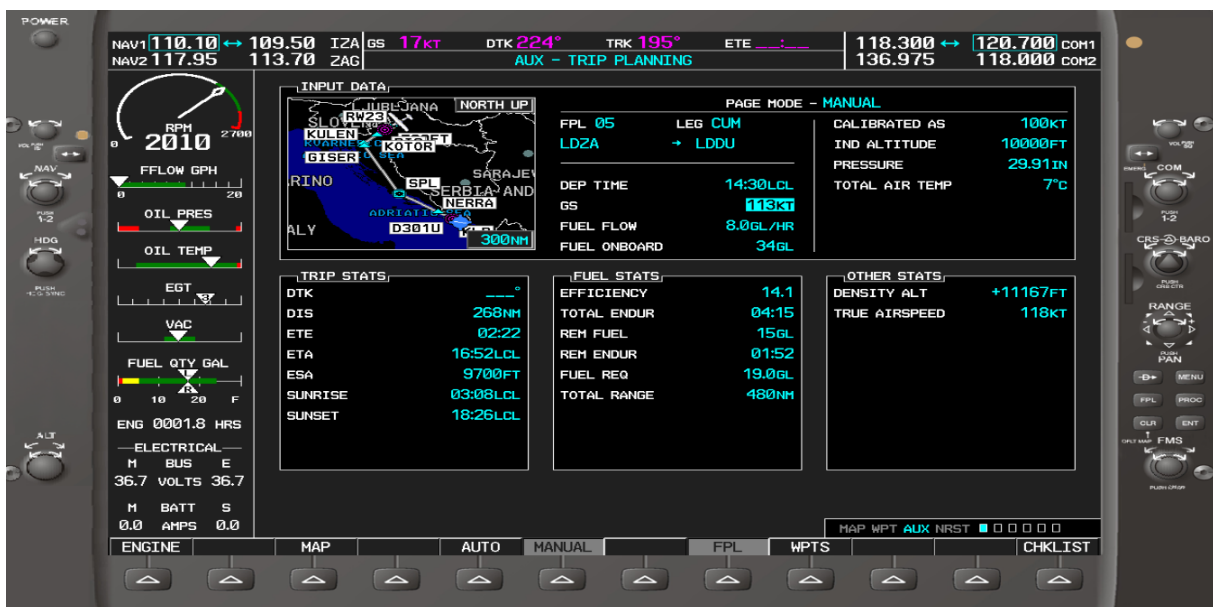
Slika 18. Planiranje rute G1000 sustavom
