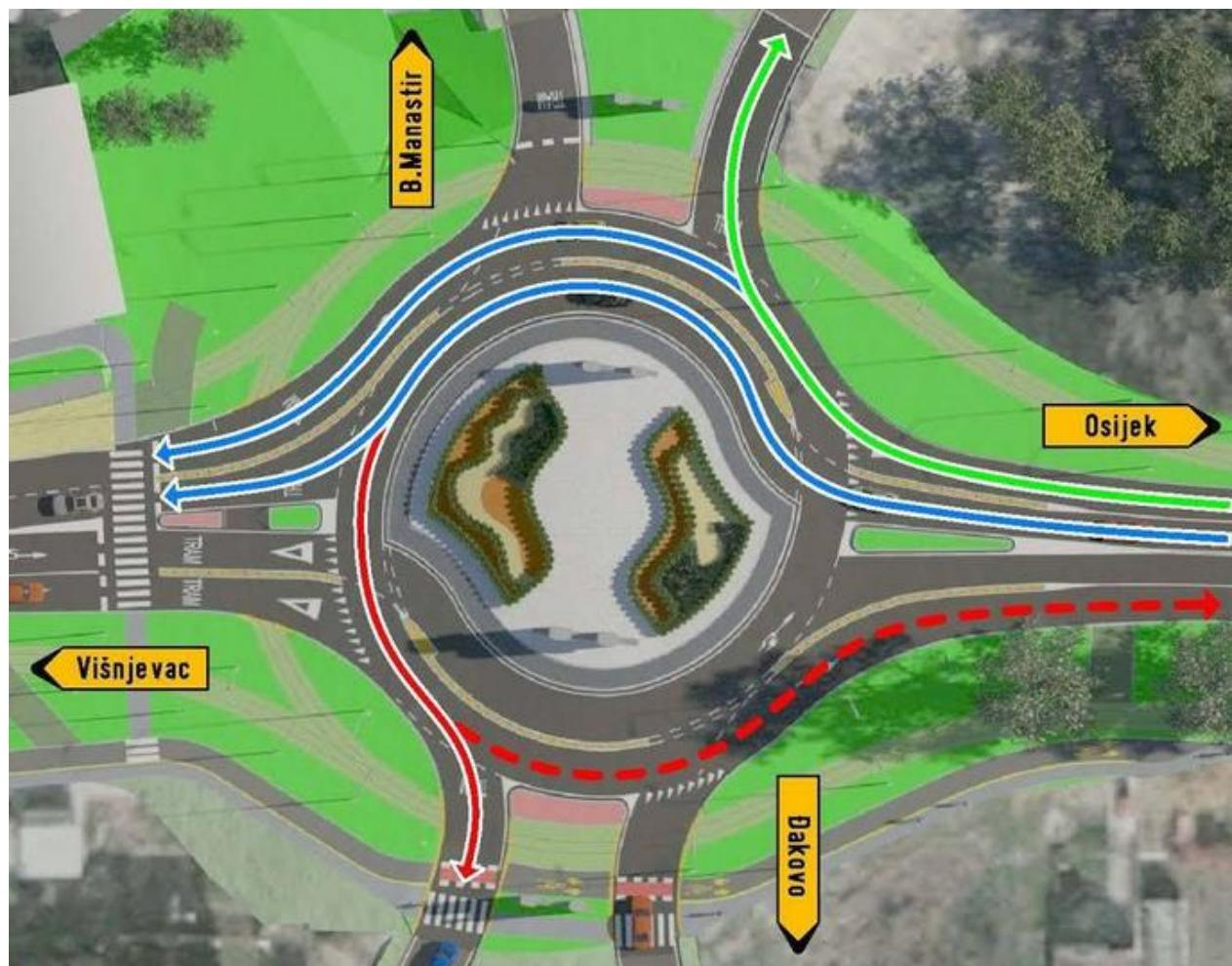
Slika 10.: Turbo rotor u Osijeku [6]
