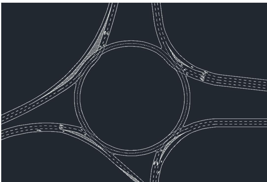
Slika 11.: Rotor u Remetincu kao Turbo rotor (izradila autorica)
