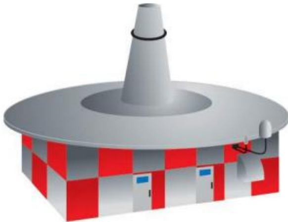
Slika 13. Primjer zemaljske postaje VOR u radijalima
