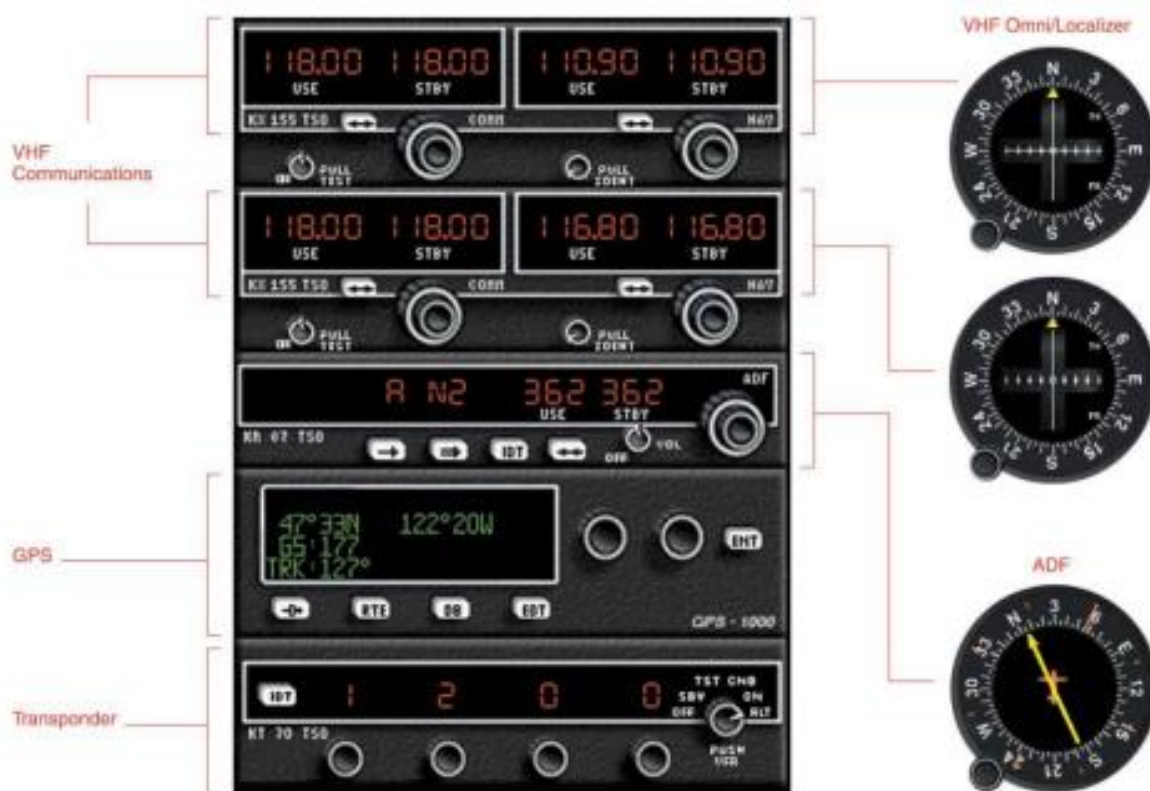
Slika 14. Prikaz kontrolne ploče u suvremenom zrakoplovu
