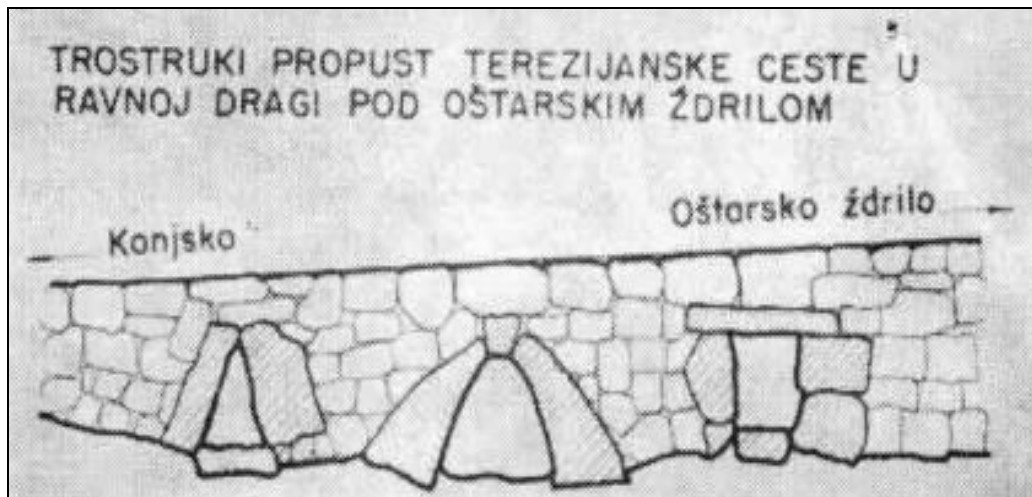
Slika 16. Propusti za oborinske vode na Terezijani
