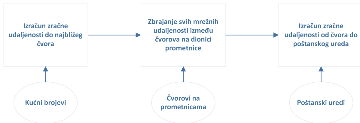
Slika 22. Proces korištenja čvorova za izračun mrežnih udaljenosti
